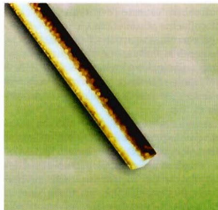
Fig. 3 - Visione allo stereomicroscopio (40 X) della punta dell'ago Endo-Eze System 22 G (gruppo 2).
