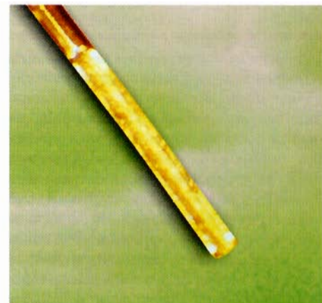
Fig. 4 - Visione allo stereomicroscopio (40 X) della punta dell'ago Monoject (gruppo 3).
