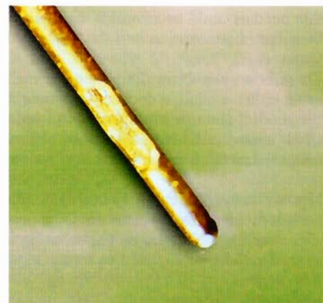
Fig. 2 - Visione allo stereomicroscopio (40 X) della punta dell'ago Max-I-Probe (gruppo 1).
